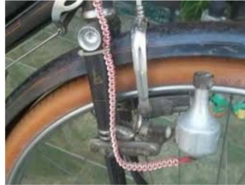
Gambar 4.3. Dinamo Sepeda digunakan untuk menyalakan lampu
